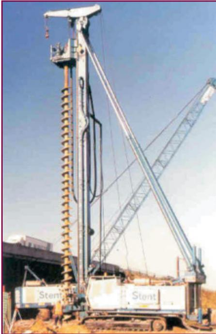
SIRIS-equipped piling rig
